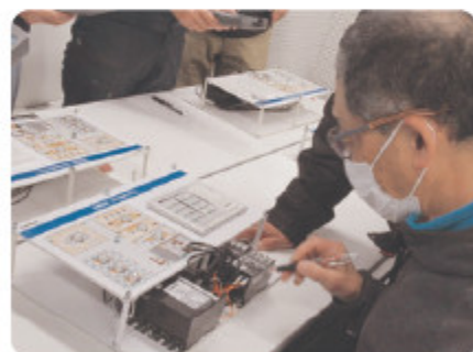
実機(リレー制御用 TU)にアドレス設定中
