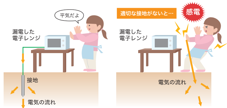
保安用接地(保護接地)の役割
