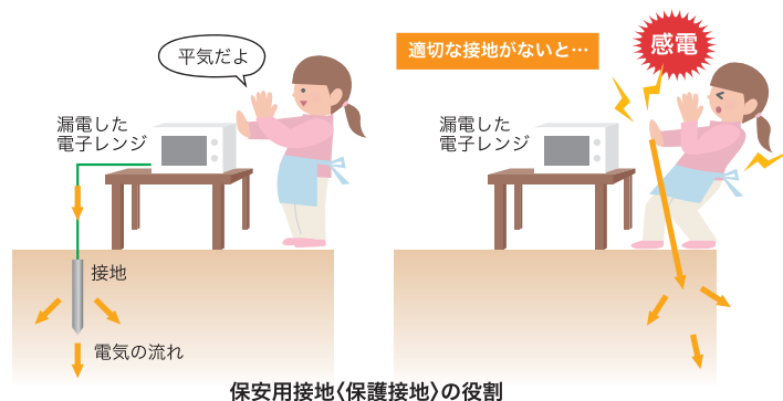
保安用接地(保護接地)の役割
