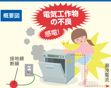
接地に漏電電流が流れることで漏電電流を感知。漏電発生と同時に電気回路遮断。
